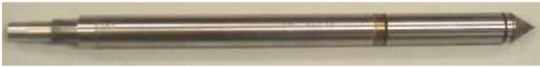
Particolare del piezocono
