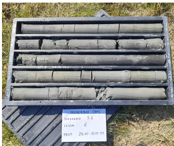
Figura 11 Casse catalogatrici sondaggio S1
