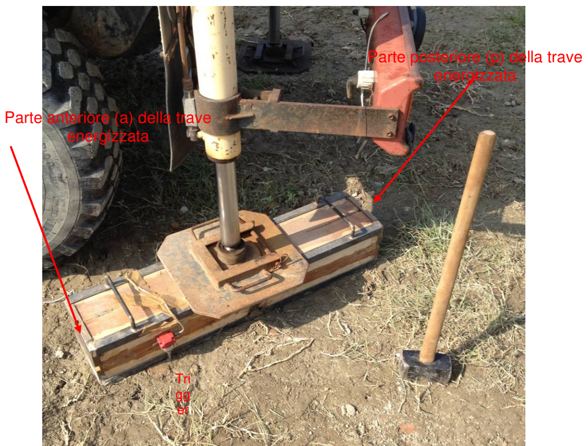
Particolare del sistema di energizzazione
