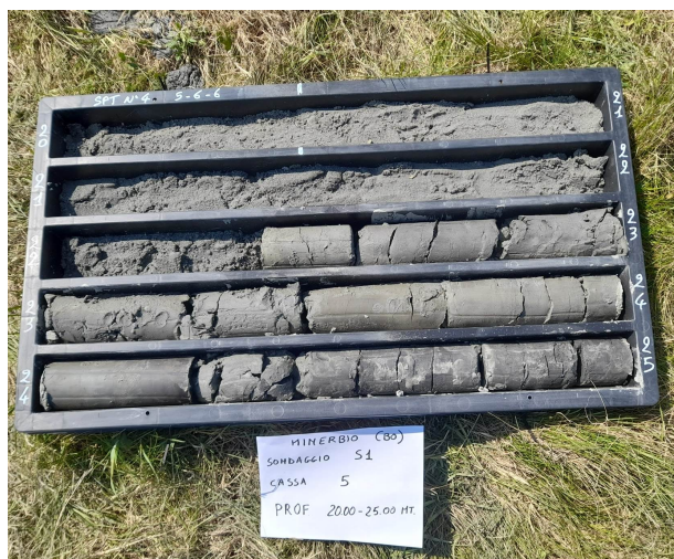
Figura 11 Casse catalogatrici sondaggio S1
